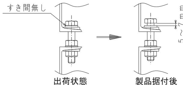
図 8 ストッパーボルト締結状態
