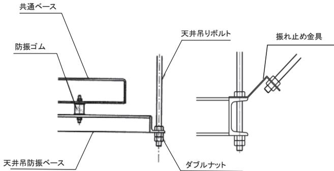
図 5 天吊り取り付け例
