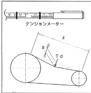
図 11 ベルトたわみ荷重測定法
