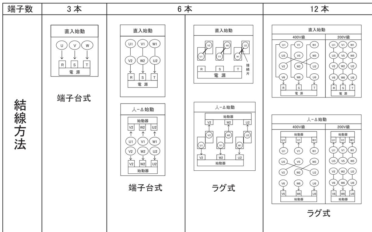
※上記の結線方法での電動機回転方向は、電動機の軸端から見て反時計回転となります。
